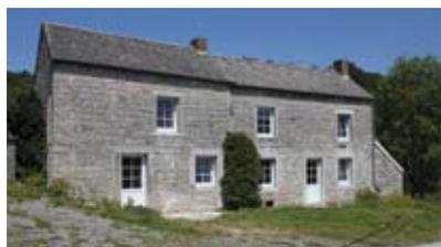
Par son **volume simple**, haut de deux *niveaux* et **peu profond**, cette bâtisse répond à la typologie du bâti traditionnel condrusien. L'impression d'élancement de l'ensemble est amplifiée par la toiture à deux **versants** courts et symétriques. L'usage de matériaux locaux, comme la pierre calcaire, contribue à son appartenance au **Condroz**.
